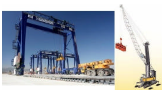
Fig. 8: Grúa ASC (izquierda) y grúa Liebherr LMH 500 (derecha).
